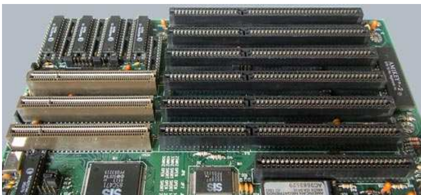
Płyta główna ze złączami VESA Local Bus
