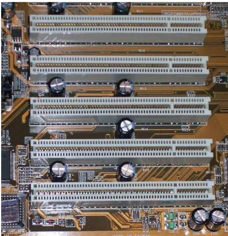
Płyta główna z gniazdami 32-bitowej szyny PCI
