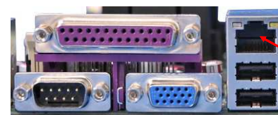
Złącze 8P8C na płycie głównej
