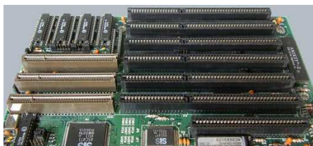
Płyta główna ze złączami VESA Local Bus
