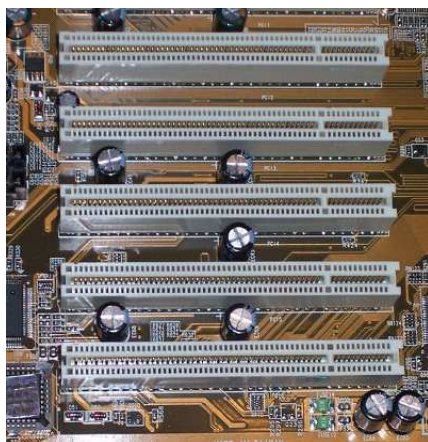
Płyta główna z gniazdami 32-bitowej szyny PCI
