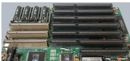
Płyta główna ze złączami VESA Local Bus
