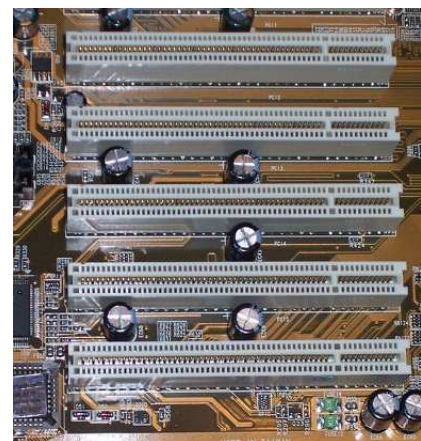
Płyta główna z gniazdami 32-bitowej szyny PCI
