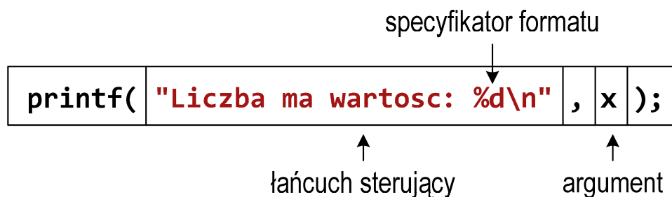
Rys. 1. Struktura funkcji printf()
