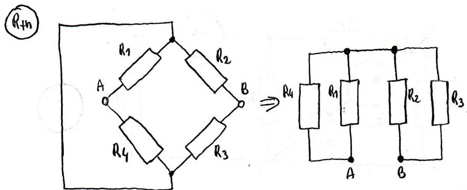
$$R_{th} = \frac{R_1 \cdot R_4}{R_1 + R_4} + \frac{R_2 \cdot R_3}{R_2 + R_3} = \frac{4 \cdot 4}{4+4} + \frac{12 \cdot 4}{12+4} = 2 + 3 = \boxed{5 \Omega}$$
