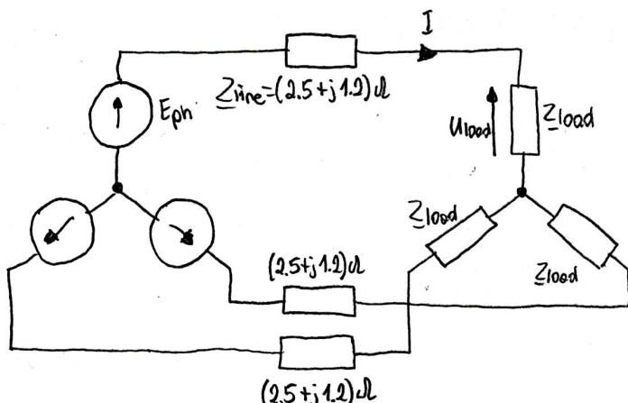
$$I = \frac{E_{\text{ph}}}{Z_{\text{line}} + Z_{\text{load}}}$$
